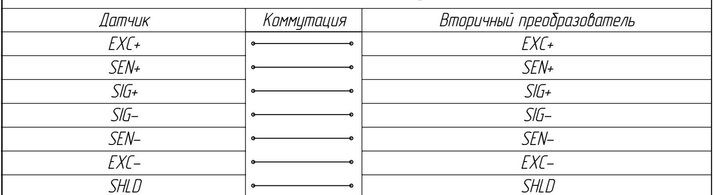
Подключение по 4-х проводной схеме к терминалу, не поддерживающему компенсацию длины кабеля и разности температур
