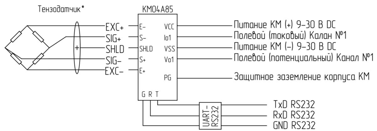
Калибровка полевого сигнала 4-20 мА и 0-10 В осуществляется через встроенный цифровой интерфейс RS232. Для соединения, используются жилы T; R; GND. Подключение к ПК осуществляется через UART(TTL)-RS232 или через UART(TTL)->USB. Порядок калибровки согласно РЭ КМО4АХХ.
